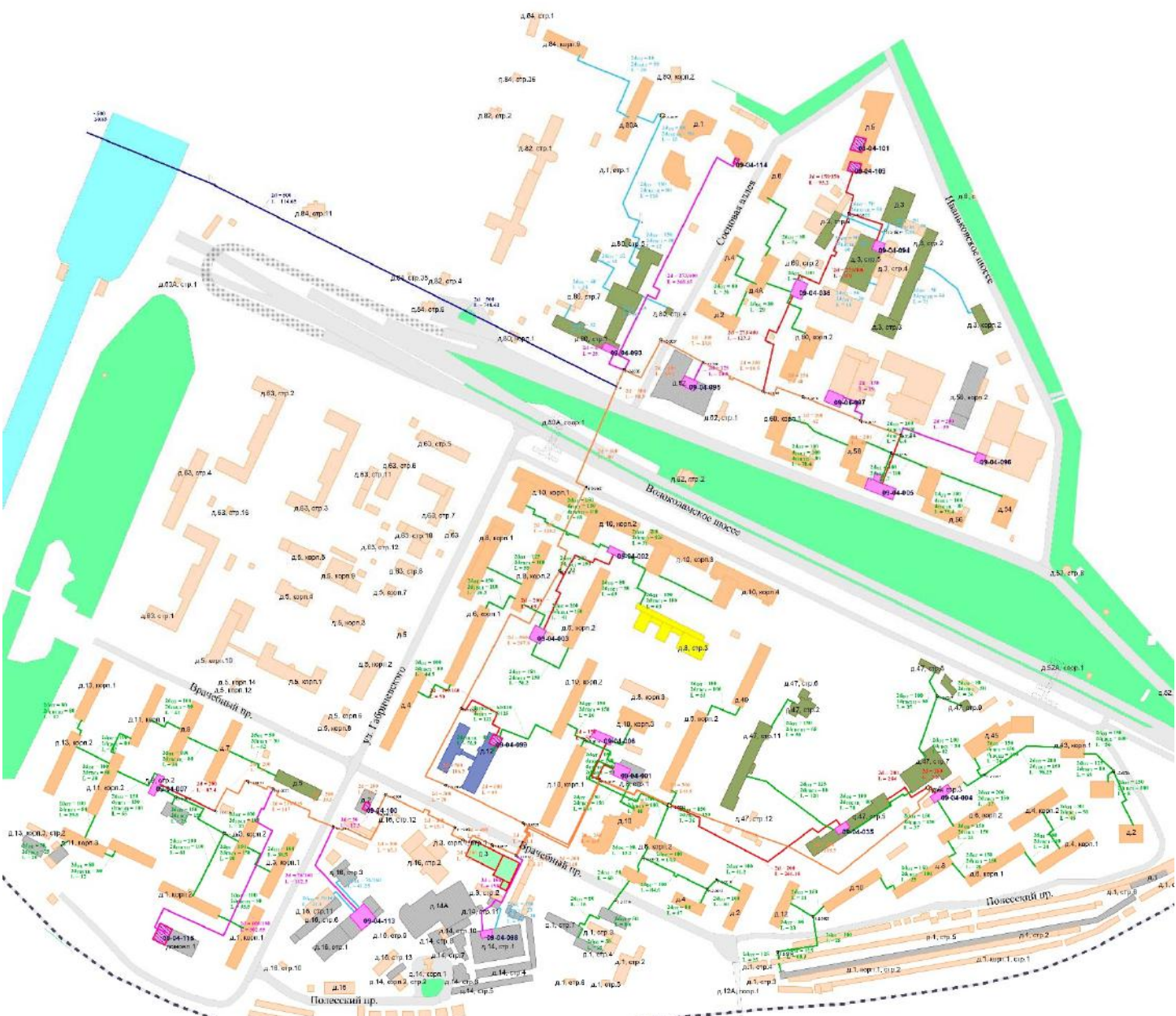
Рисунок Б.7.1 - Схема тепловых сетей от КТС «Покровско-Стрешнево»
