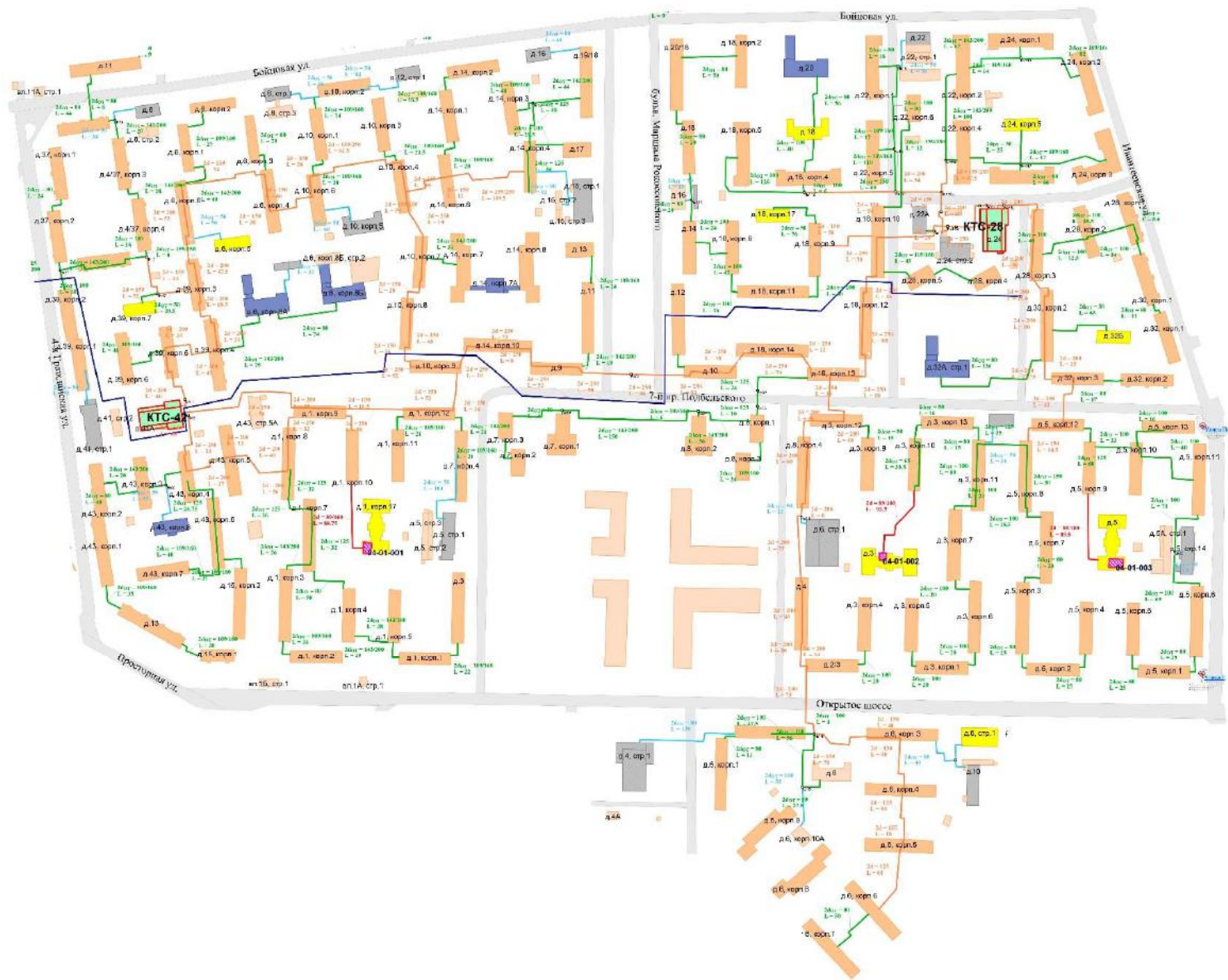
Рисунок Б.3.1 - Схема тепловых сетей от КТС-28 и КТС-42
