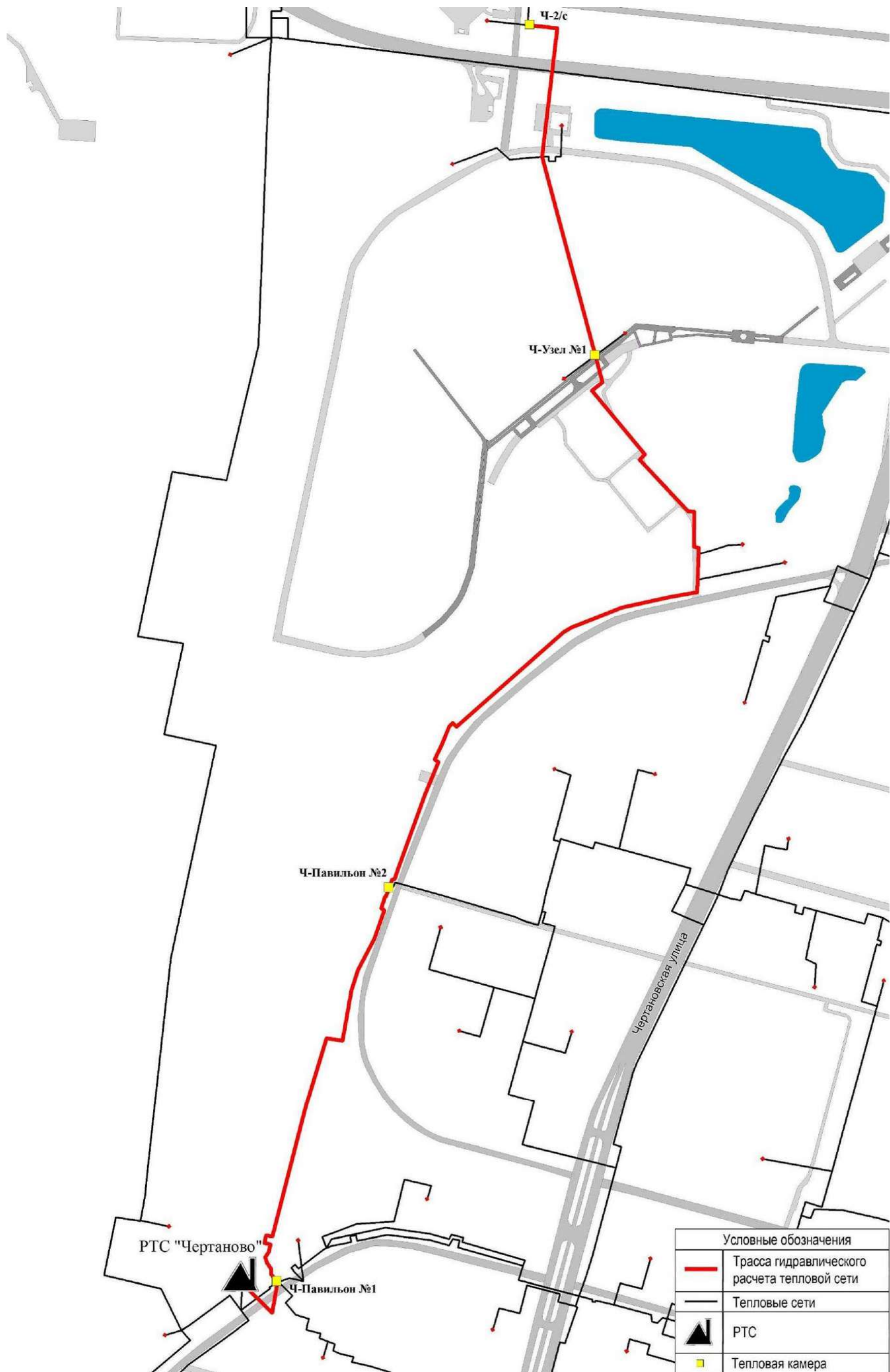
Рисунок Ж.27.3 - Схема гидравлического расчета тепловых сетей от РТС "Чертаново" до камеры Ч-2/с
