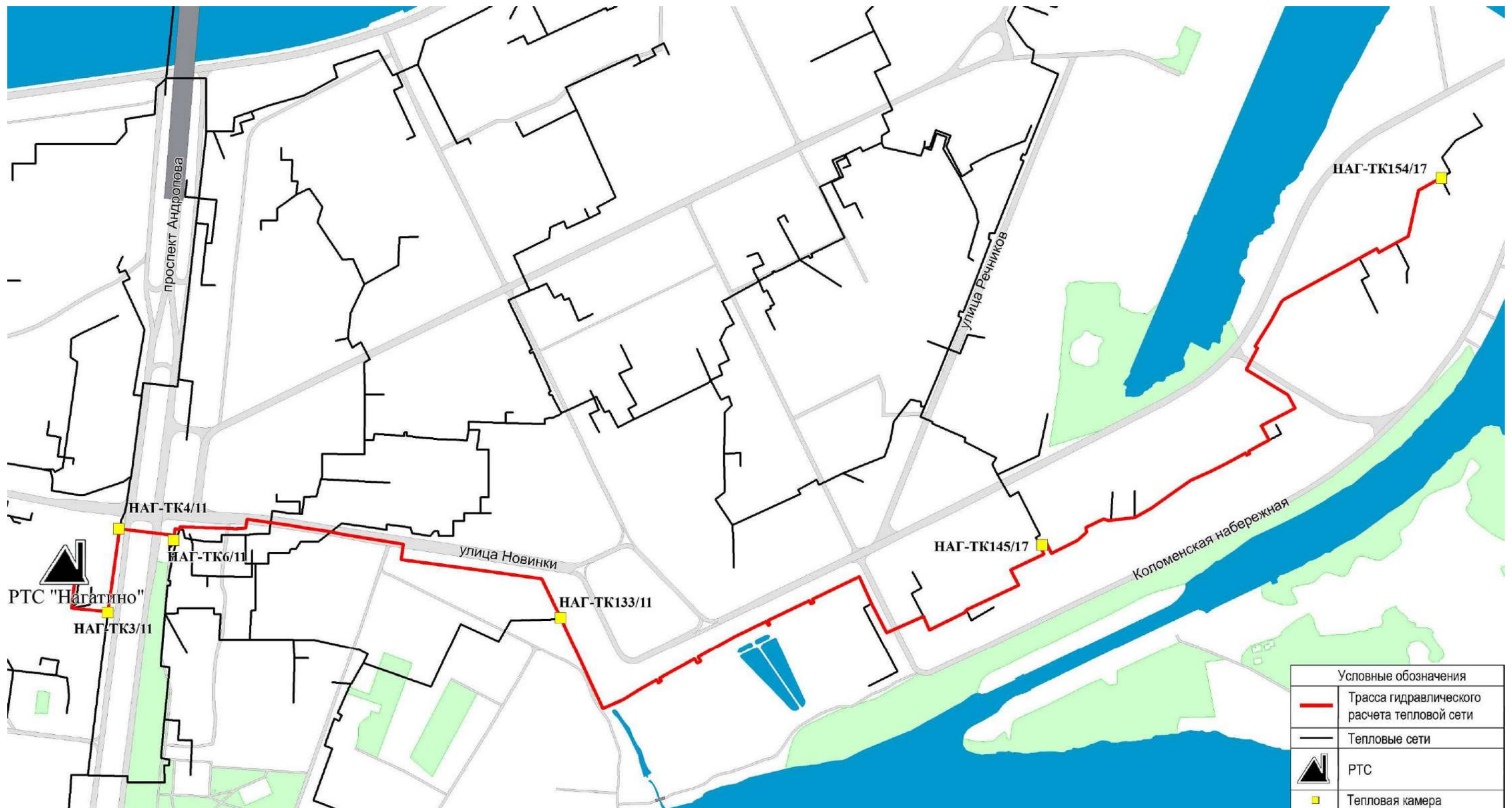
Рисунок Ж.14.1 - Схема гидравлического расчета тепловых сетей от РТС «Нагатино» до камеры НАГ-ТК154/17
