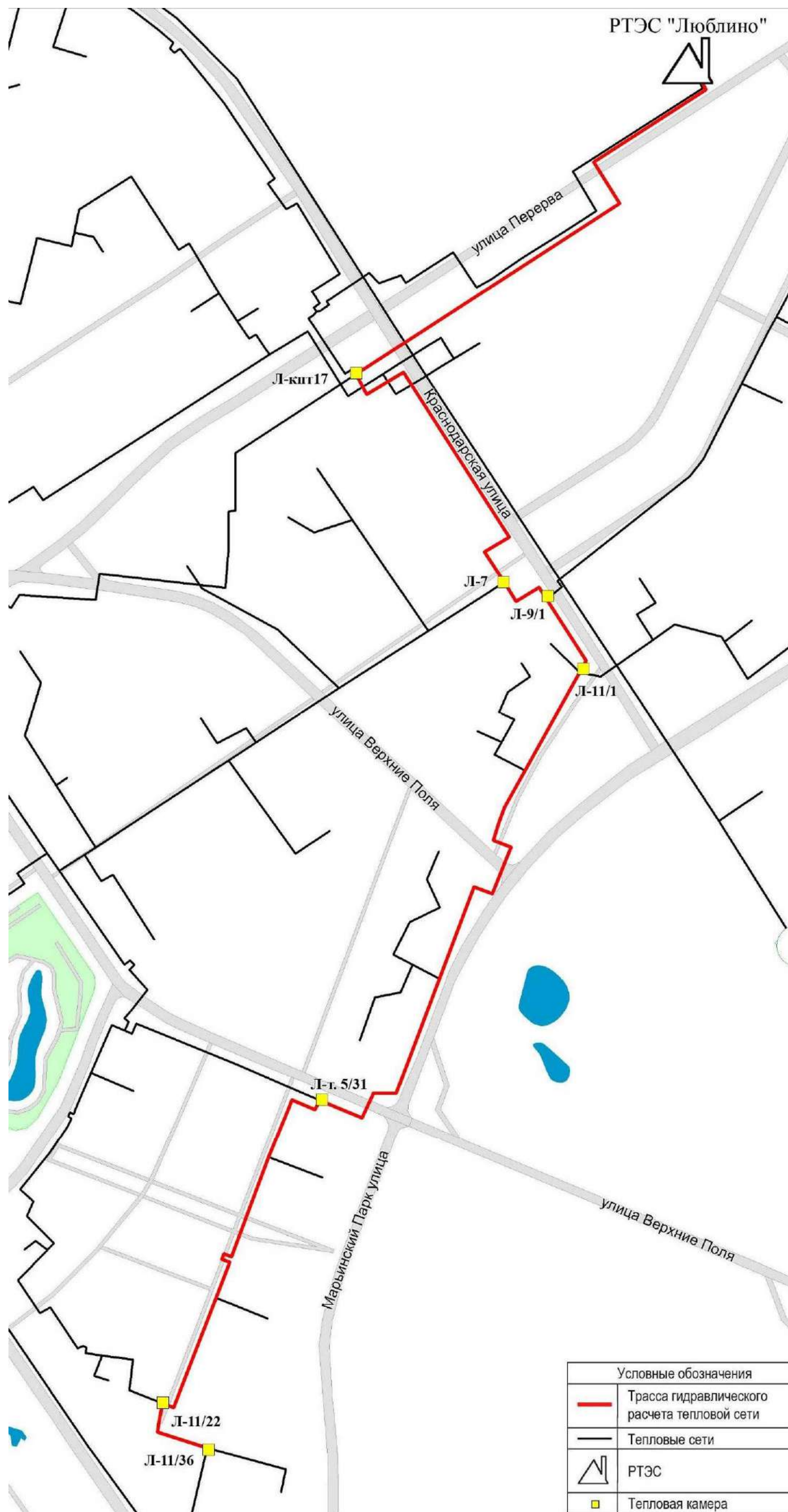
Рисунок Ж.20.1 - Схема гидравлического расчета тепловых сетей от РТЭС «Люблино» до камеры Л-11/36
