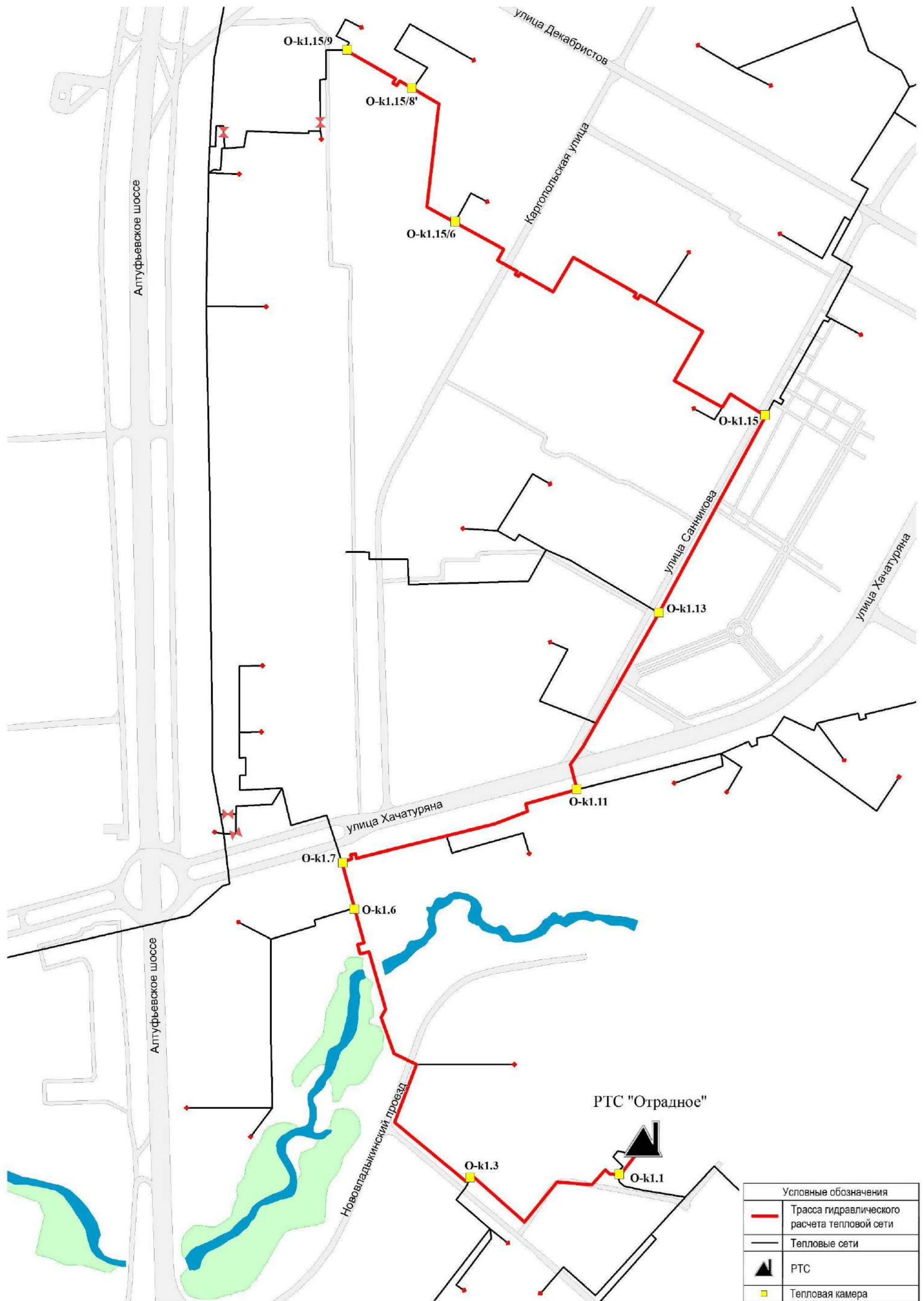
Рисунок Ж.16.1 - Схема гидравлического расчета тепловых сетей от РТС «Отрадное» до камеры «O-k1.15/9»
