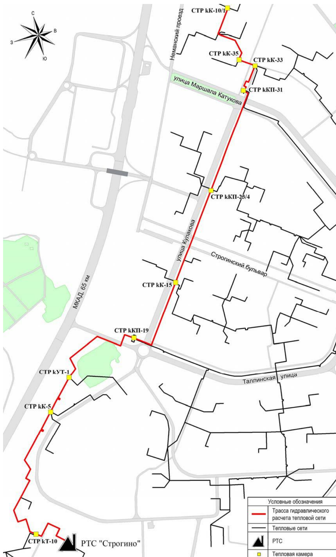
Рисунок И.5.1 - Схема гидравлического расчета тепловых сетей от РТС «Строгино» до камеры «СТР кК-10»
