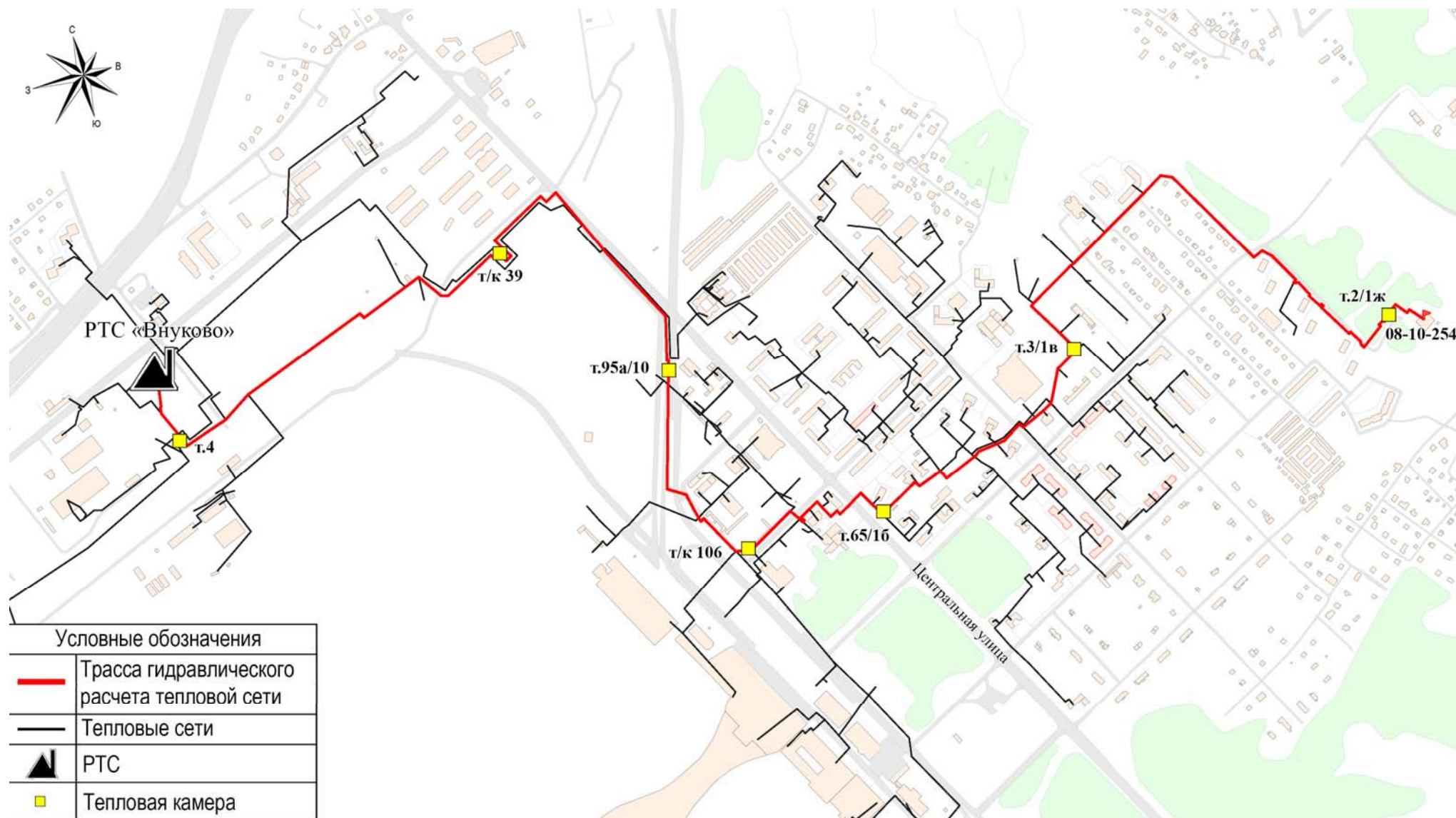
Рисунок И.3.1 - Схема гидравлического расчета тепловых сетей от РТС «Внуково» до ЦТП 08-10-254
