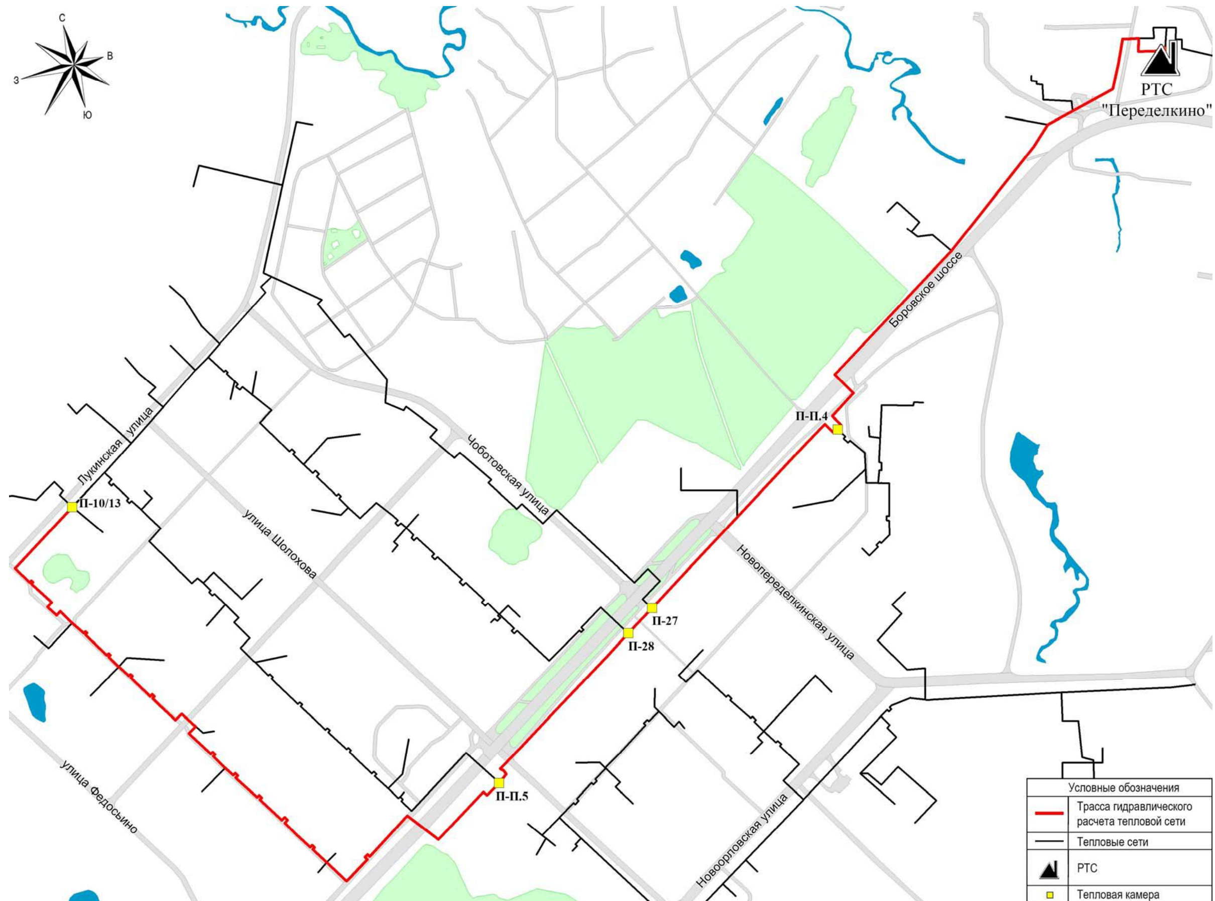
Рисунок И.2.1 - Схема гидравлического расчета тепловых сетей от РТС «Перedelкино» до камеры П-10/13
