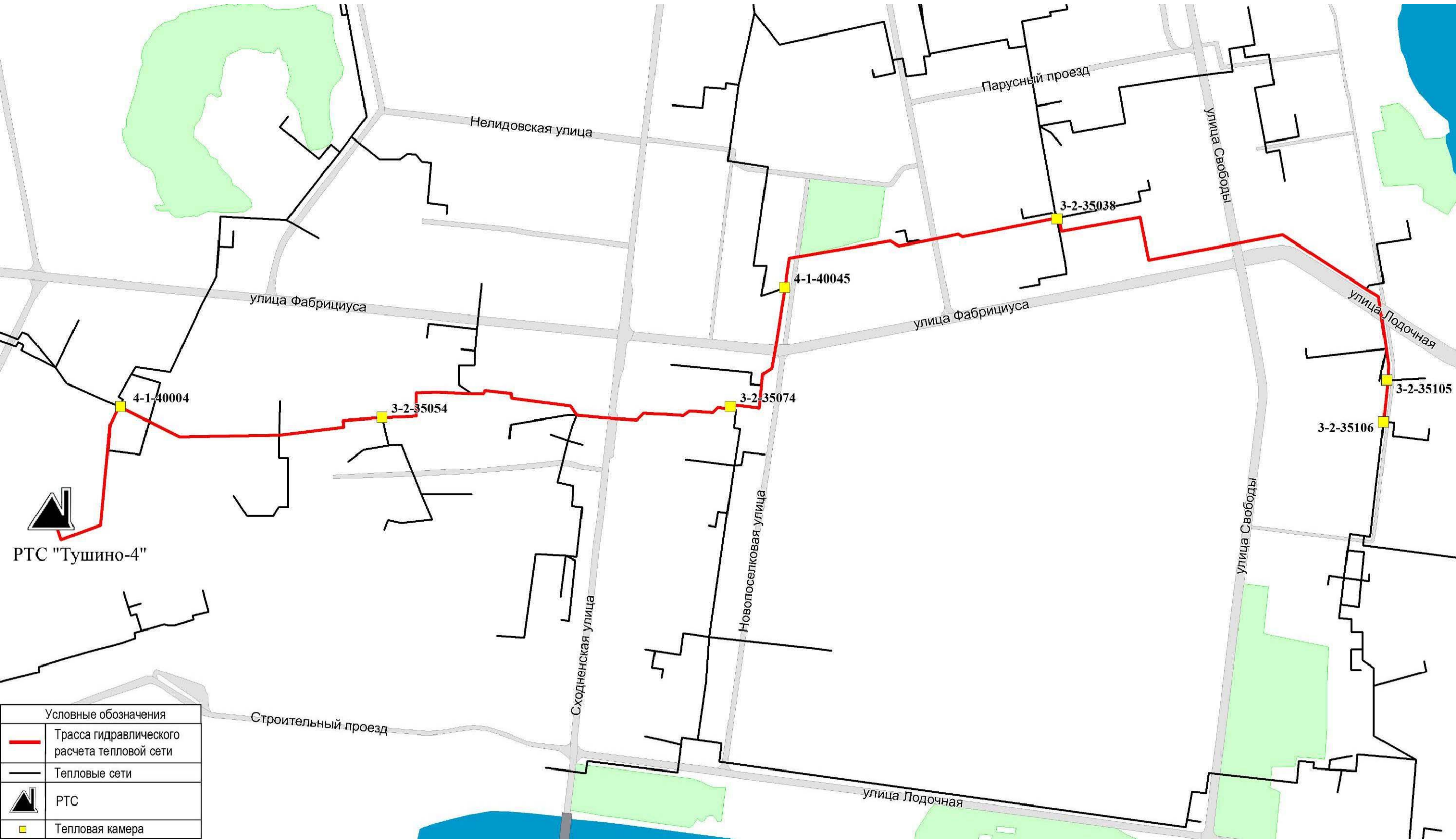
Рисунок И.9.1 - Схема гидравлического расчета тепловых сетей от РТС «Тушино-4» до камеры «3-2-35106»
