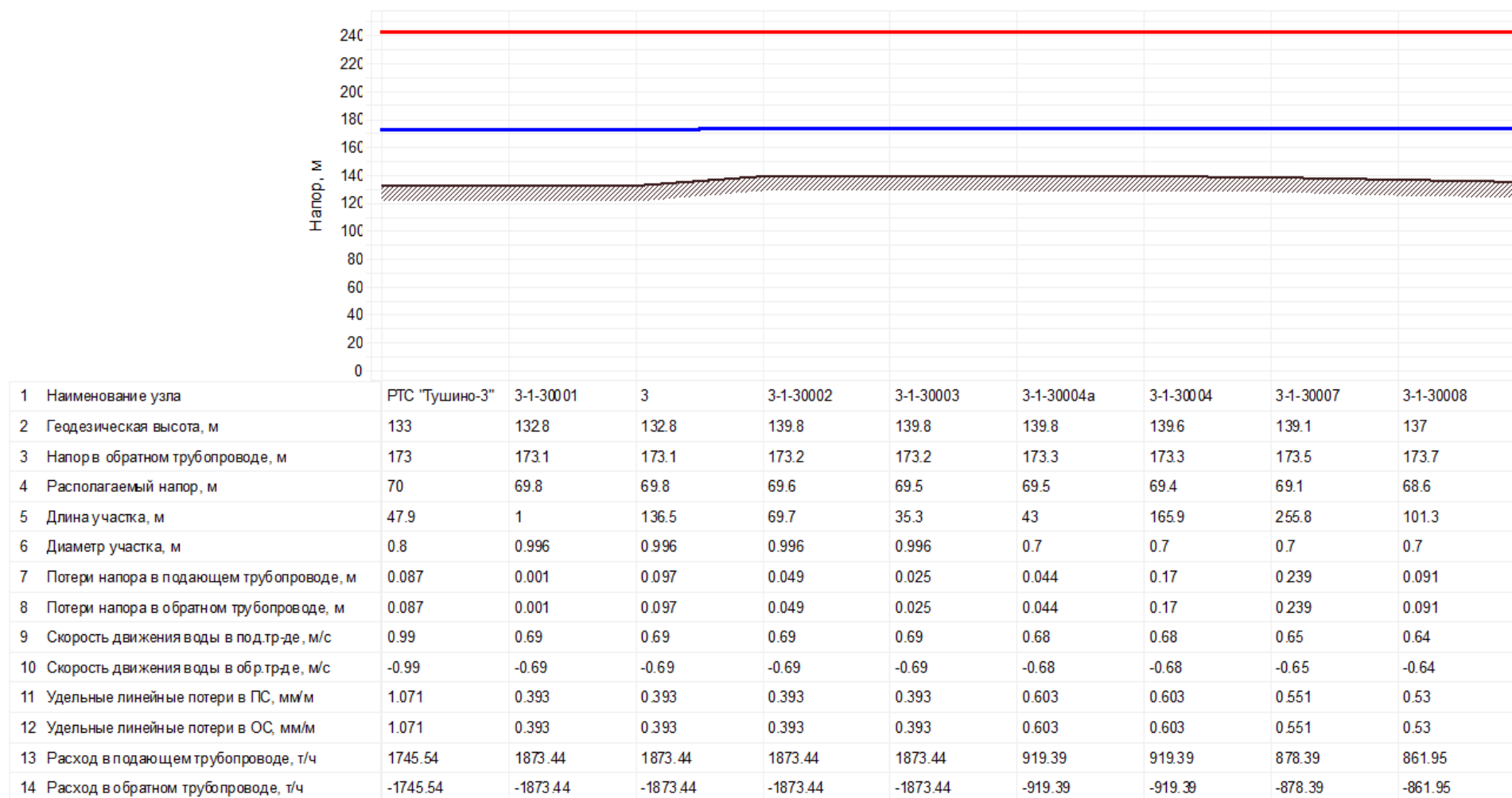
Рисунок И.8.4 - Пьезометрический график от РТС «Тушино-3» до камеры «3-2-35112»
