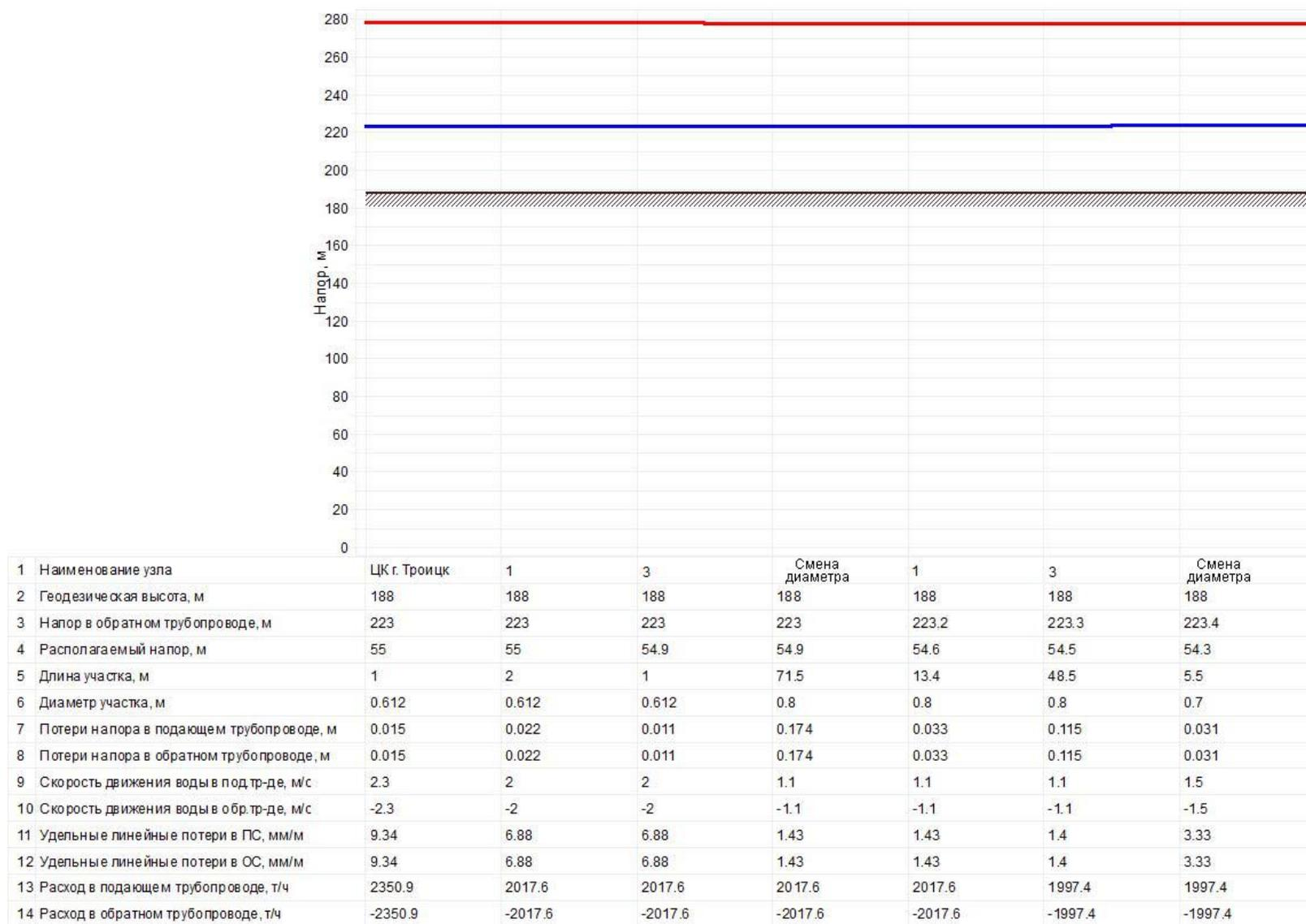
Рисунок К.4.8 – Пьезометрический график от котельной Центральная МУП «Троицктеплоэнерго» до камеры ЦТП Е-39А
