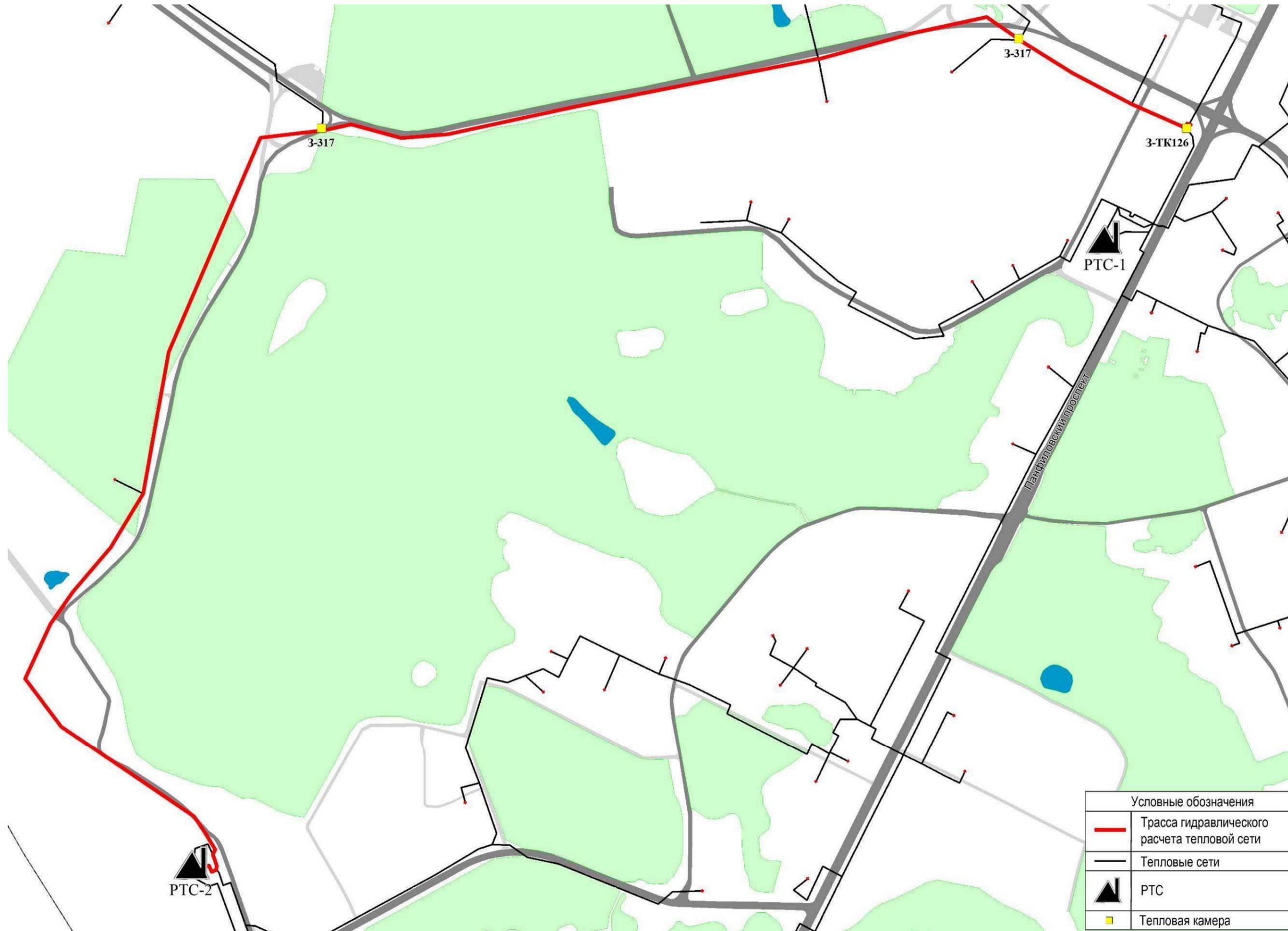
Рисунок К.1.3 - Схема гидравлического расчета тепловых сетей от РТС-2 до камеры 3-ТК126
