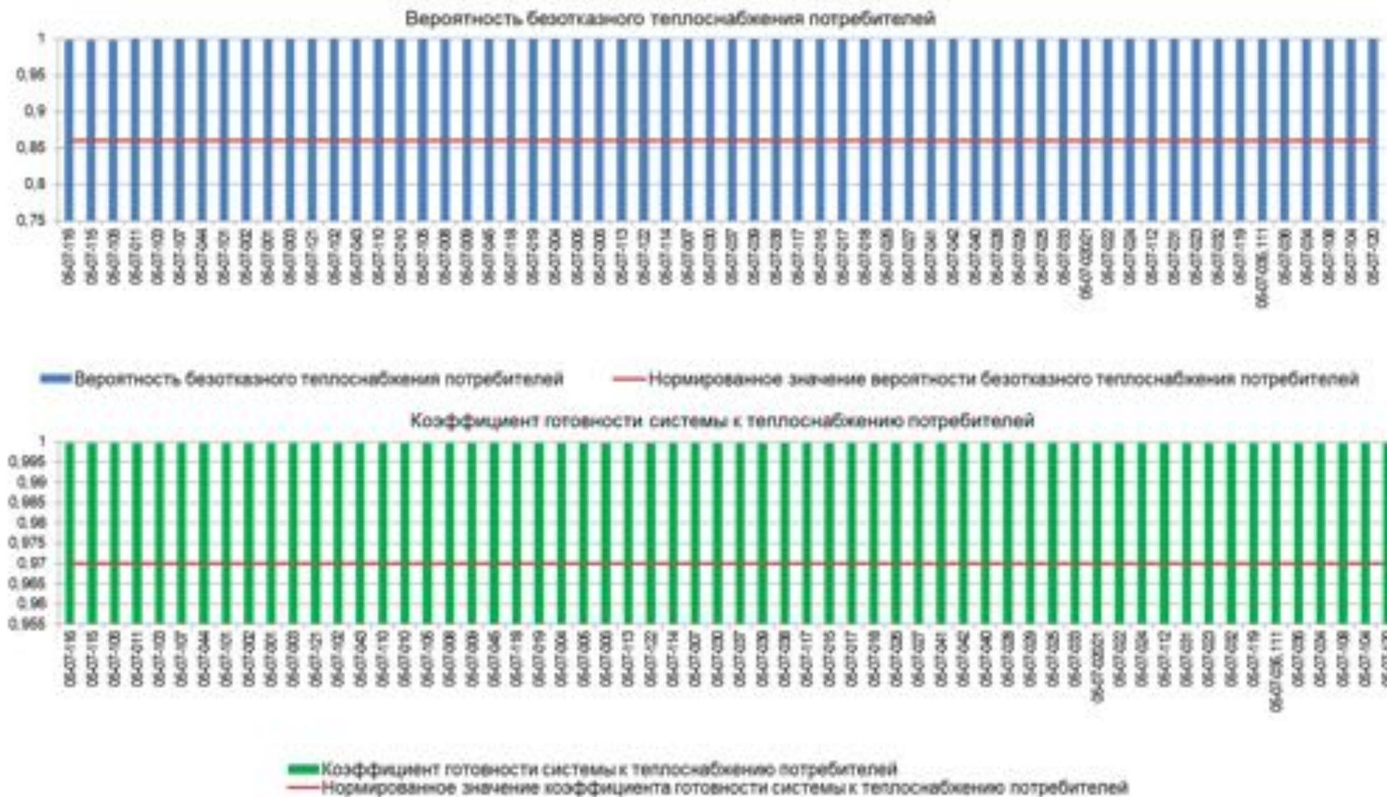
Рисунок А.33 – Вероятность безотказного теплоснабжения и коэффициент готовности системы к теплоснабжению потребителей
