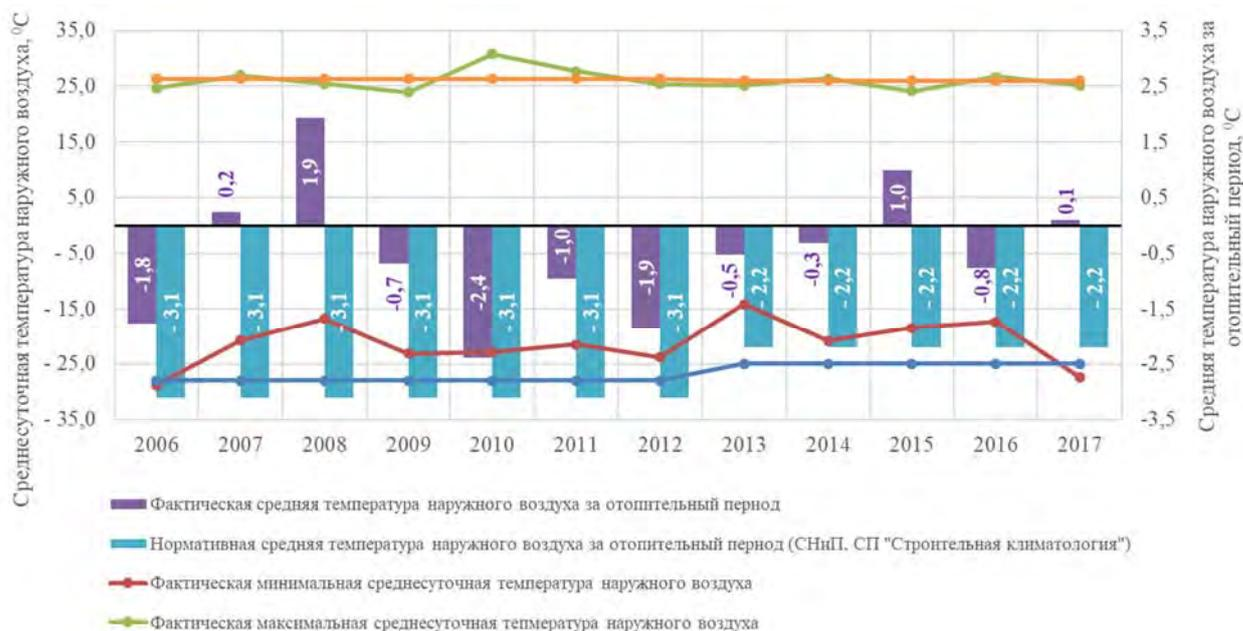
Рисунок 2.2 - Динамика нормативных и фактических среднесуточных температур наружного воздуха и средней температуры наружного воздуха за отопительные периоды 2006-2017 гг.
