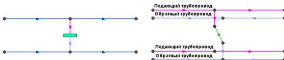
Рисунок 2.34 - Соединение между подающим трубопроводом одного участка и обратным трубопроводом другого участка в однолинейном изображении сети и ее внутреннем представлении
