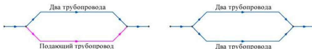
Рисунок 2.10 - Изображение трехтрубной и четырехтрубной сети
