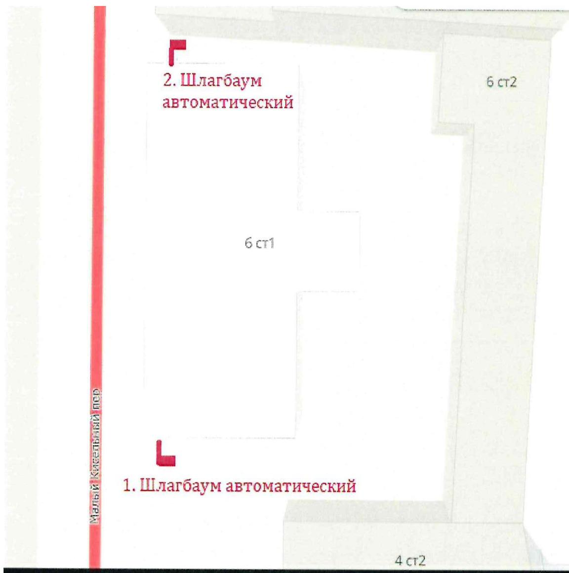
Цифрами 1 и 2 обозначены места размещения ограждающих устройств (шлагбаумов).
